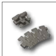
878T TAB Verstärkte Platte Enger Radius (200 mm) Tlg. 1 ½" (38,1 mm) Dicke 4,8 mm (0.189") Scharnier 42,9 mm (1.689")
