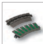
HFX 1873T 双体链 勾角型转弯 节距 3/4" (19,05 mm) 厚度 4 mm (0.157") 铰链 32,1 mm (1.264")
